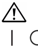
Las fuentes de alimentación para el Sistema TriPlus RSH/TriPlus 100 LS y el módulo Temperature Controlled Drawer muestran los símbolos I/O en el interruptor de alimentación para indicar "encendido"/ "apagado".
