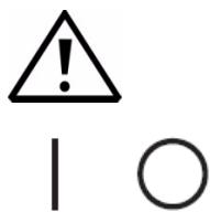
As fontes de alimentação do Sistema TriPlus RSH/TriPlus 100 LS e do módulo de gavetas Temperature Controlled Drawer possuem os símbolos I/0 na etiqueta do interruptor para indicar LIGAR/DESLIGAR.
